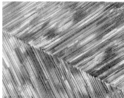
Fig. 6.3 b: Eine aus zwei Martensitvarianten zusammengewachsene keilförmige Martensitplatte (x50.000)
