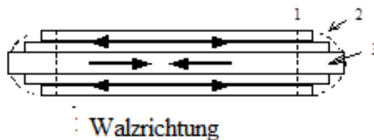
Abb. 6.1. Entstehung von Innenspannungen in einem Metallband aufgrund verschiedener Höhenabnahme in Zentral- und Seitenschichten eines durchs Tonnenwalzen gestauchten Metallbandes (Schema): 1 – Ausgangs-länge, 2 – Endform und -länge, 3 – Zentralschicht beim freien Stauchen (ohne Zusammenwirken mit ihren benachbarten Schichten).
