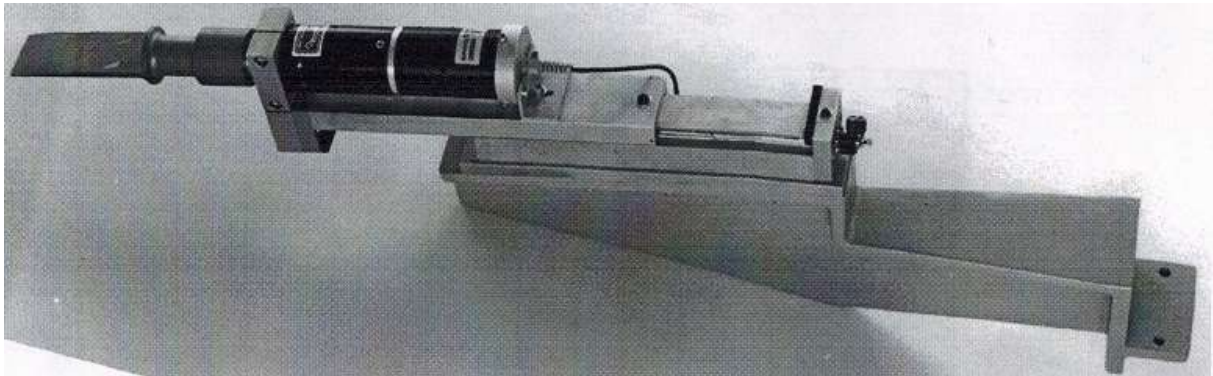
35kHz Standard-Linearvorschubsystem mit US-Schwingkopf, bestehend aus Konverter, Booster und Sonotrode
