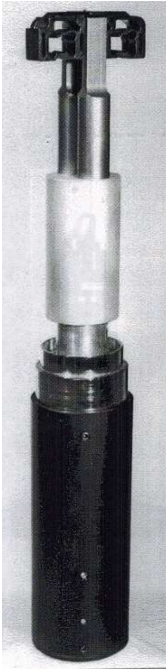
Ein 35\text{kHz} Schwingersystem in „Mutter-Töchter-Anordnung“
